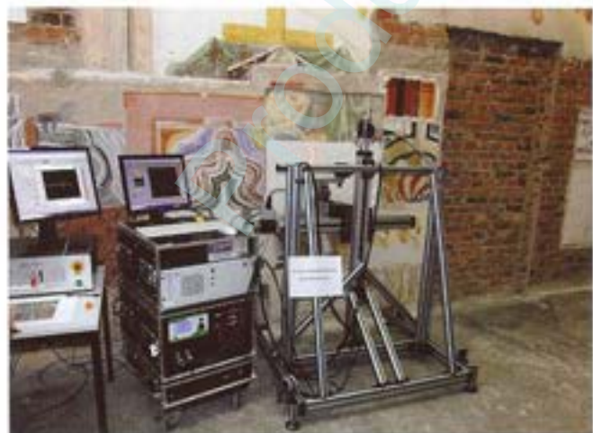
Abb. 5: THz-TDS-Wandscannersystem bei Vorort-Messungen an Wandmalereikopien
